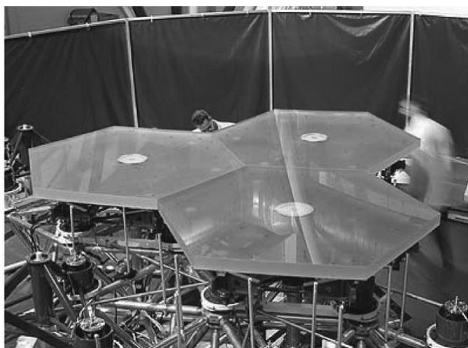
Fig. 5. – Schema per la focalizzazione del fascio ultraintenso (a sinistra) e (a destra) specchi adattativi segmentati, realizzati dalla SAGEM per il GTC (Gran Telescopio Canarias; vedi <http://www.gtc.iac.es/>).
